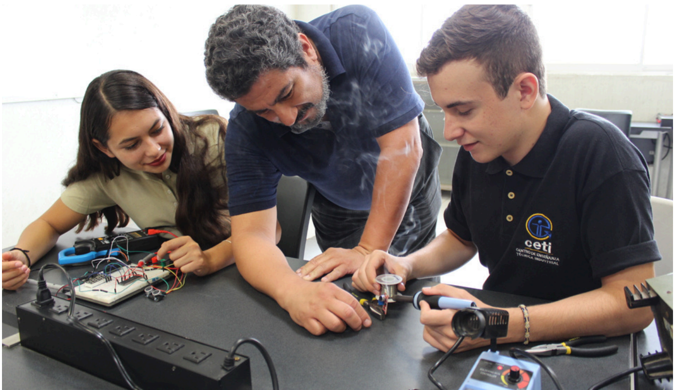
PPI: Circuito armado y reporte de práctica de una polarización del BJT en sus diferentes zonas de trabajo.
